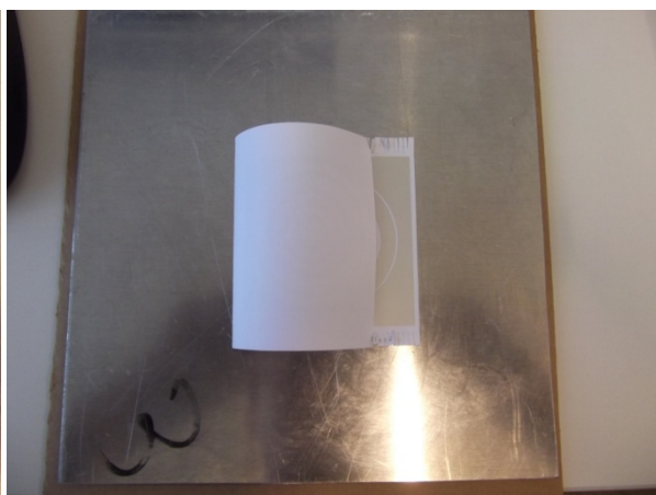
Abbildung 135: UHF-(Reflektor)-Antennenkonfiguration + RFID-Chip auf einer Aluminiumplatte (200 mm x 200 mm)
