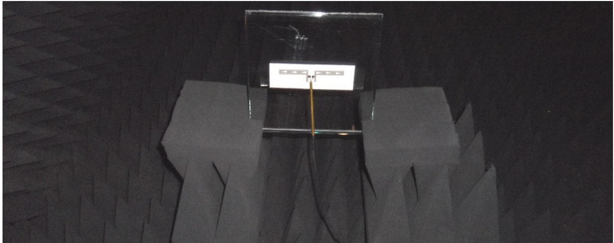
Abbildung 71: Messaufbau der Antenne in der Absorberkammer auf dem dielektrischen Substrat (Kombination Glass & PMMA)
