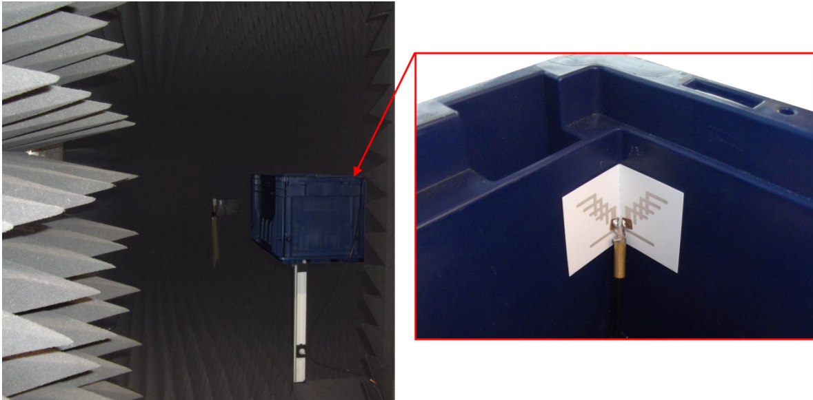
Abbildung 161: Messaufbau und elektrische Kontaktierung der gedruckten 3D-Semifraktalen-Dipolantenne zur Vorbereitung auf die messtechnische Charakterisierung in einer Absorberkammer
