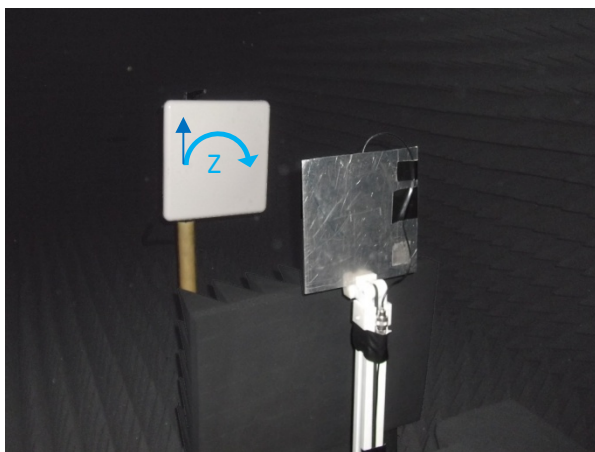
Abbildung 115: Messaufbau 3 mit rechtszirkular polarisierter Empfangsantenne
