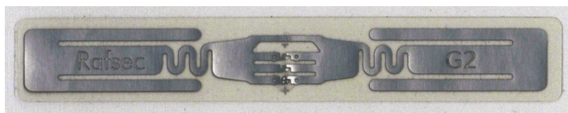
Abbildung 37: 868 MHz UHF-RFID-Transponder-Antenne "Rafsec G2" [Quelle: www.upmraflatac.com ]
