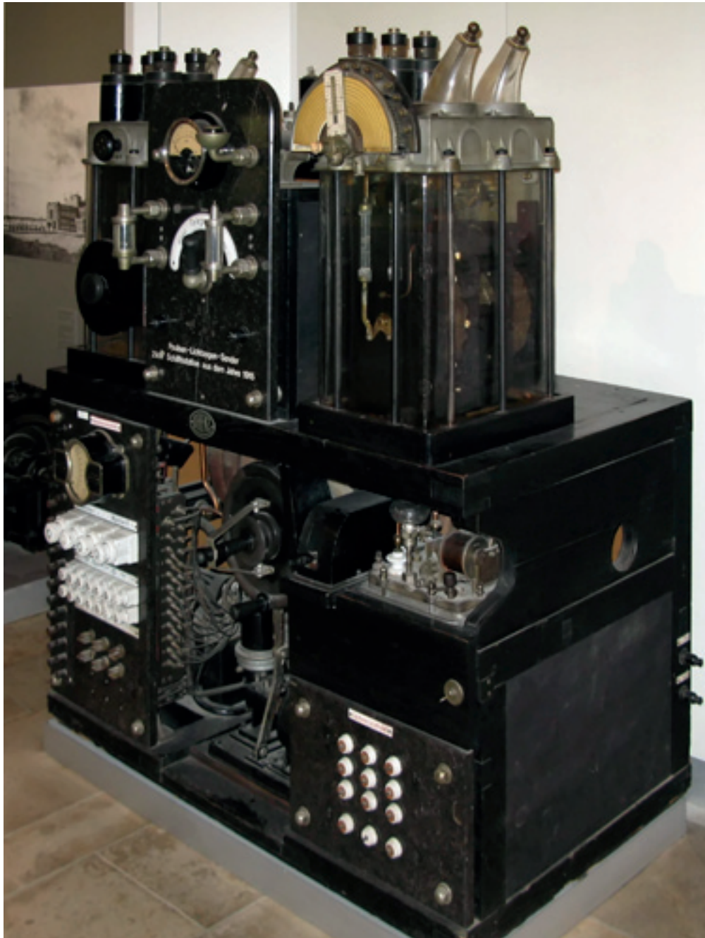
Ansicht eines Lichtbogensenders nach Poulsen
