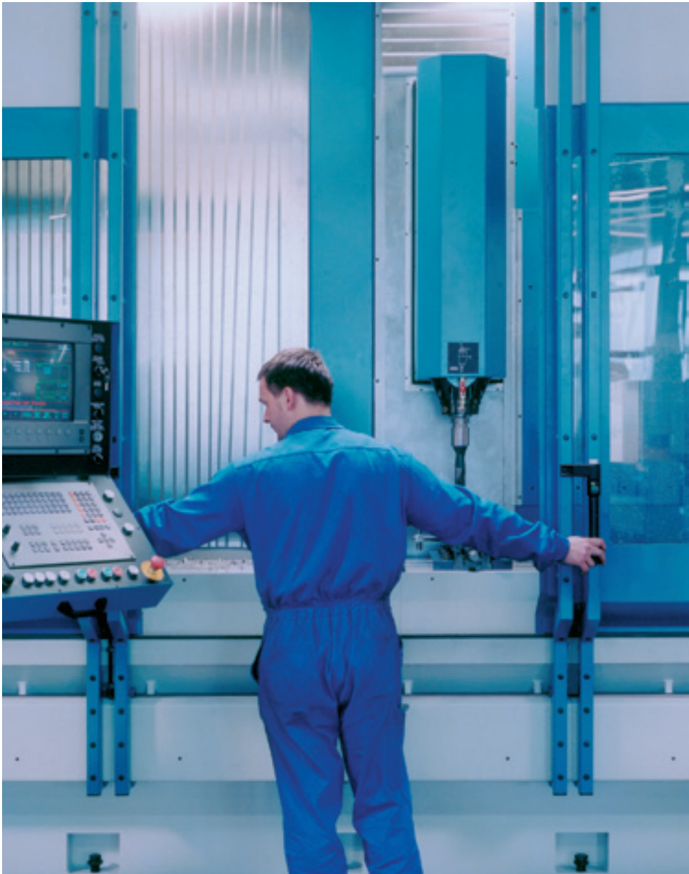
Beispiel für die ersten Applikationen des »Energy Harvesting« in der Industrieautomation: Ein Türgriffschalter aus dem TGF-Programm an seitlich verschiebbaren Schutztüren ermöglicht den Verzicht auf verschleißanfällige Kabelschleppereinrichtungen
