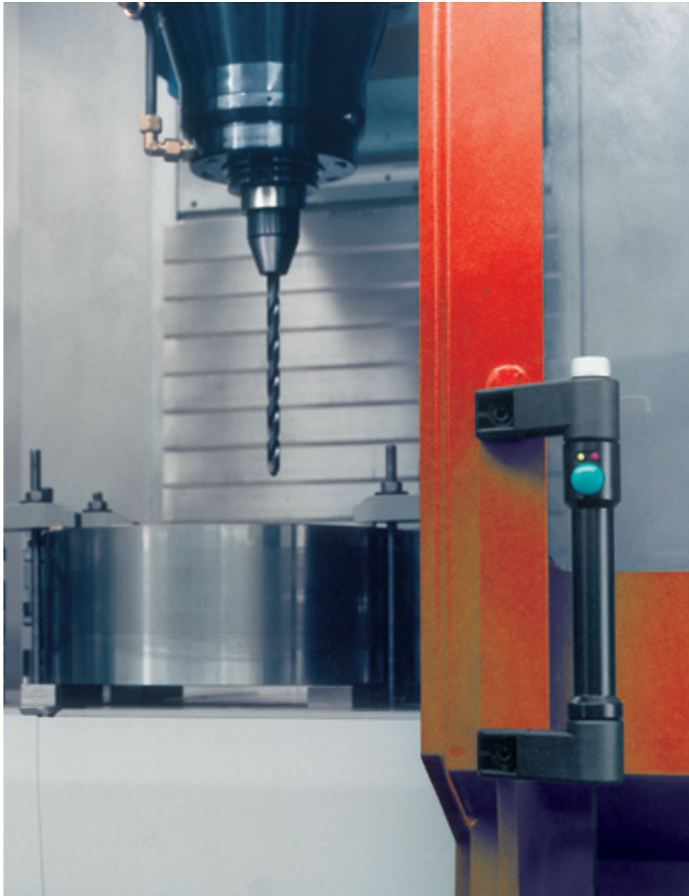
Eine der ersten Anwendungen der EnOcean-Technologie in der Industrie: Funk-Türgriffschalter an einer Werkzeugmaschine.
